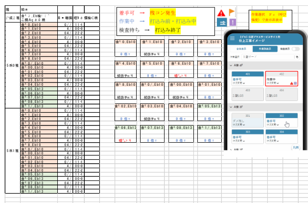
図2 大阪万博における生コンシェアのマッチング画面の検討
