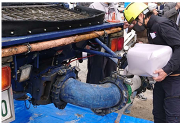
写真 17 ポンプ車への投入方法
