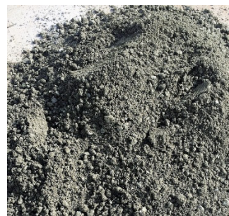
改質後の生コン(人力攪拌)
